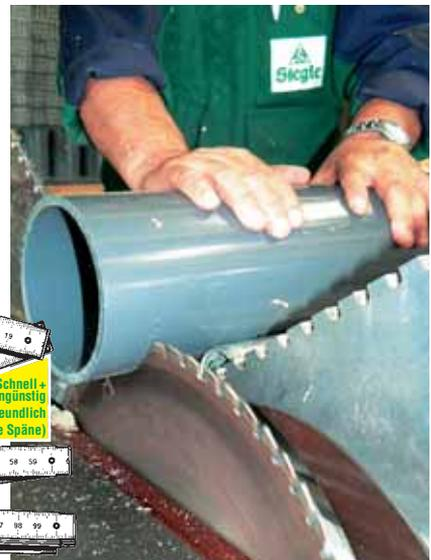
LS-Werkbild: ... beim Schneiden von Kunststoffrohren
