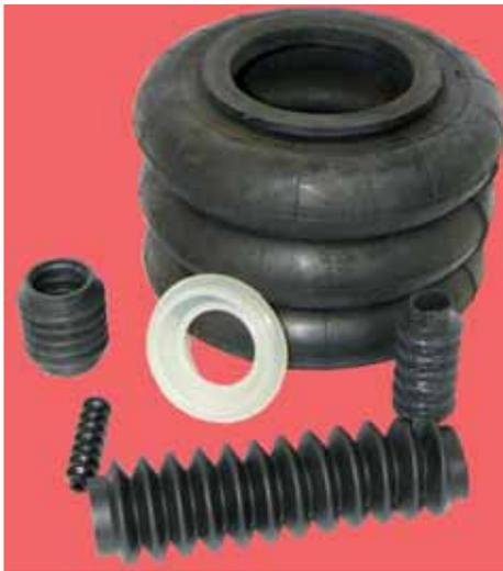
**Faltenbälge** aus NBR, CR, Silikon, W-PVC (Molerit) Erhältlich aus Lagerprogrammen mit Innendurchmessern ab 3 mm (als flexible Rohrverbindung, Kolbenschutzelement und als Stoßpuffer usw.)
